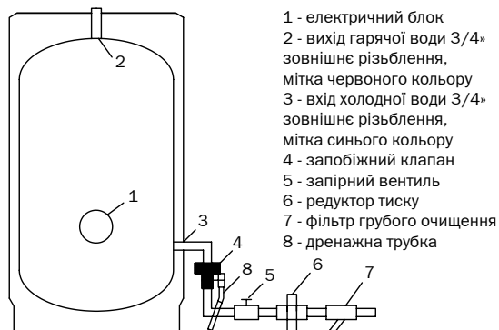
Рис.4. Схема підключення ЕВАД Steatite підлогових.
